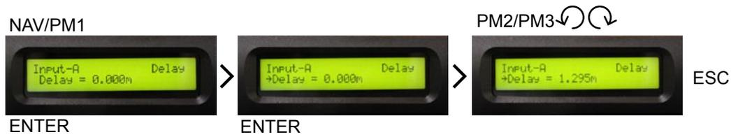
**Delay:** En esta pantalla es posible ajustar el retraso del canal de entrada de 000.0000ms(milisegundos) hasta 826.3841 ms (288.656 mts.), con pasos de 1ms o 20.8 us(microsegundos).
