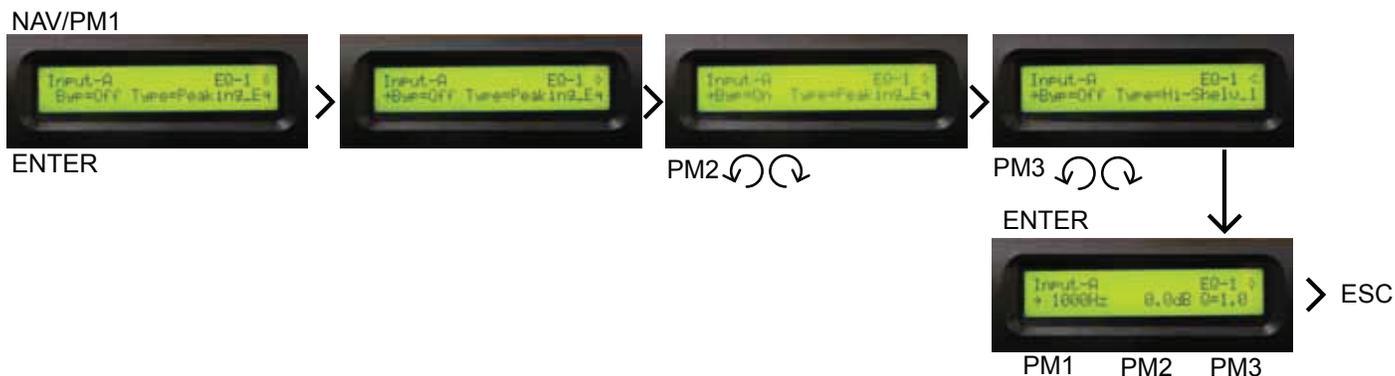
**EQ:** este ecualizador afecta a todas las señales de entrada de manera que es posible ajustar el canal de entrada con 5 bandas de ecualización, que hace casi innecesario el uso de ecualizadores gráficos externos. Cada una de las bandas cuenta con diferentes tipos de filtro:
