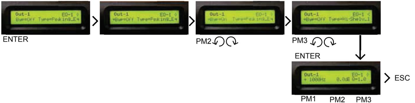
**EQ:** este ecualizador afecta a todas las señales de salida de manera que es posible ajustar el canal de salida con 5 bandas de ecualización, que hace casi innecesario el uso de ecualizadores gráficos externos. Cada una de las bandas cuenta con diferentes tipos de filtro:
